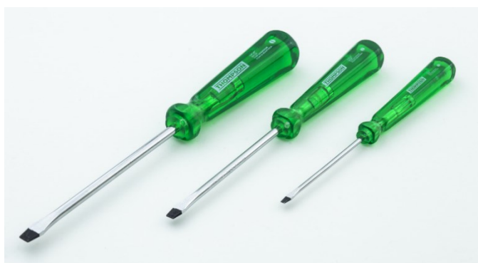
Diferentes chaves de fenda. Quanto maior a bitola do cabo, menor a força aplicada para rotacionar o eixo.
