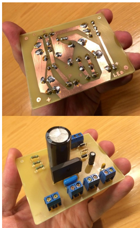
Lado inferior e superior de uma placa de circuito impresso. Os componentes colocados sobre a placas funcionam através dos circuitos impressos no lado inferior.
