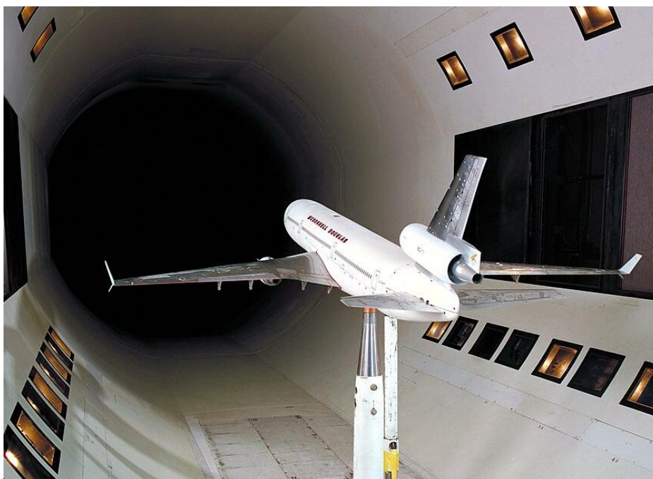
Túnel de vento da NASA, onde a aerodinâmica de uma miniatura do avião MD-11 estava sendo testada.
