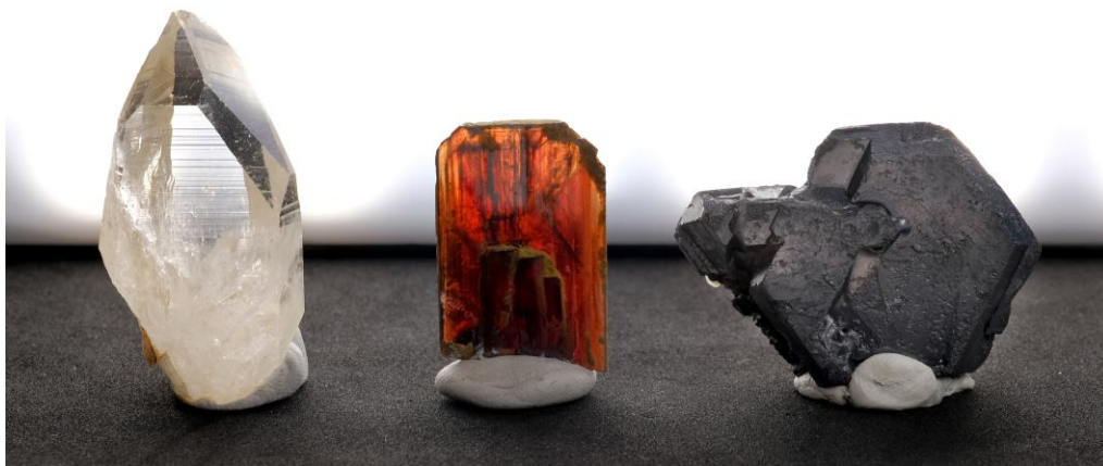
Três tipos de cristal. O primeiro é transparente (cristal de quartzo). O segundo é translúcido (cristal de brookita). O terceiro é opaco (cristal de galena).
