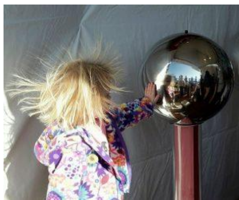
Esquema de funcionamento do gerador de Van de Graaff e seu efeito eletrostático quando uma pessoa eletricamente isolada toca a esfera metálica.
